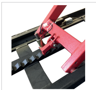
Elektromagnetische Sicherheitsklinke. Electromagnetic safety catch.
